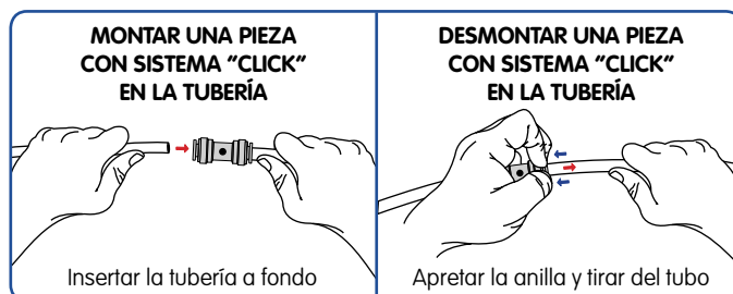
Montaje / desmontaje de las piezas con sistema "Click" en tubería
