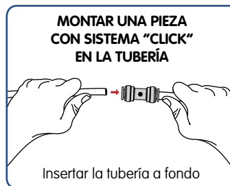
Montaje / desmontaje de las piezas con sistema "Click" en tubería
