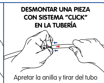
Montaje / desmontaje de las piezas con sistema "Click" en tubería
